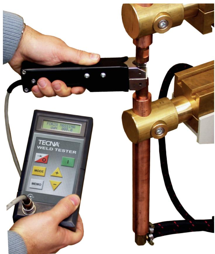
**ACCESSORI PER STRUMENTO DI MISURA MULTIFUNZIONE TE1600/RS232**
